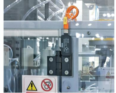
带有内置安全开关的CFSQ铰链的应用。
