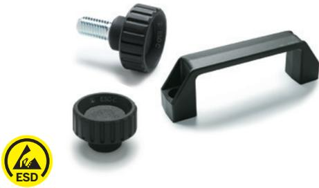
ESD线产品适用于ESD静电保护工作区 (EPA), 该区域内的零件容易受到静电放电的影响, 应将其受损危险频率降至最低。特殊导电高科技聚合物 (ESD-C静电放电传导) 可防止具有不同电位的物体之间的静电电荷积聚。每个操作件表面上激光雕刻上特殊标志ESD-C显示该产品符合EN 100015/1和IEC 61340-5-1标准的抗静电特征。
